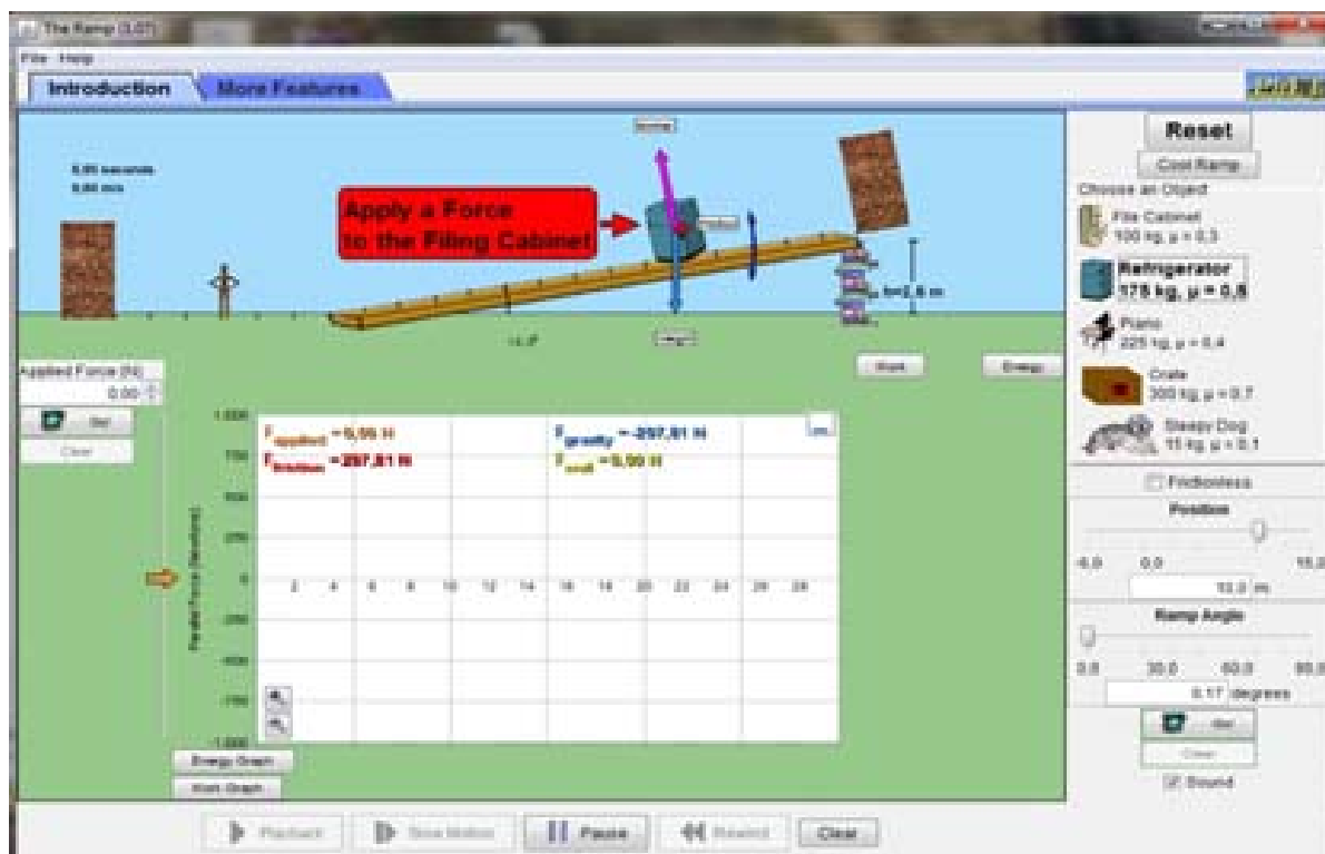
Fig.2 Lansarea unui experiment de fizică în programul de simulare PHET; Studiul planului înclinat - interfața cu utilizatorul.
